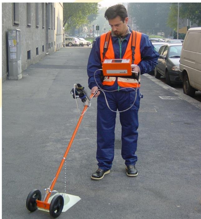
La nascita di nuove tecnologie e l'esigenza di acquisire, elaborare e gestire al meglio dati sempre più dettagliati ha portato allo sviluppo di SNIFFY, un sistema di documentazione GPS per la ricerca sistematica delle fughe gas.
